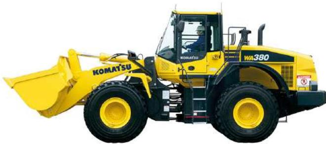
Esta máquina incorpora el sistema Komtrax con el que envía su localización, SMR y mapas de operación a una red de internet segura utilizando tecnología inalámbrica. Además, informa sobre códigos de errores, precauciones, ítems de mantenimientos, niveles de combustibles, entre otros aspectos.
